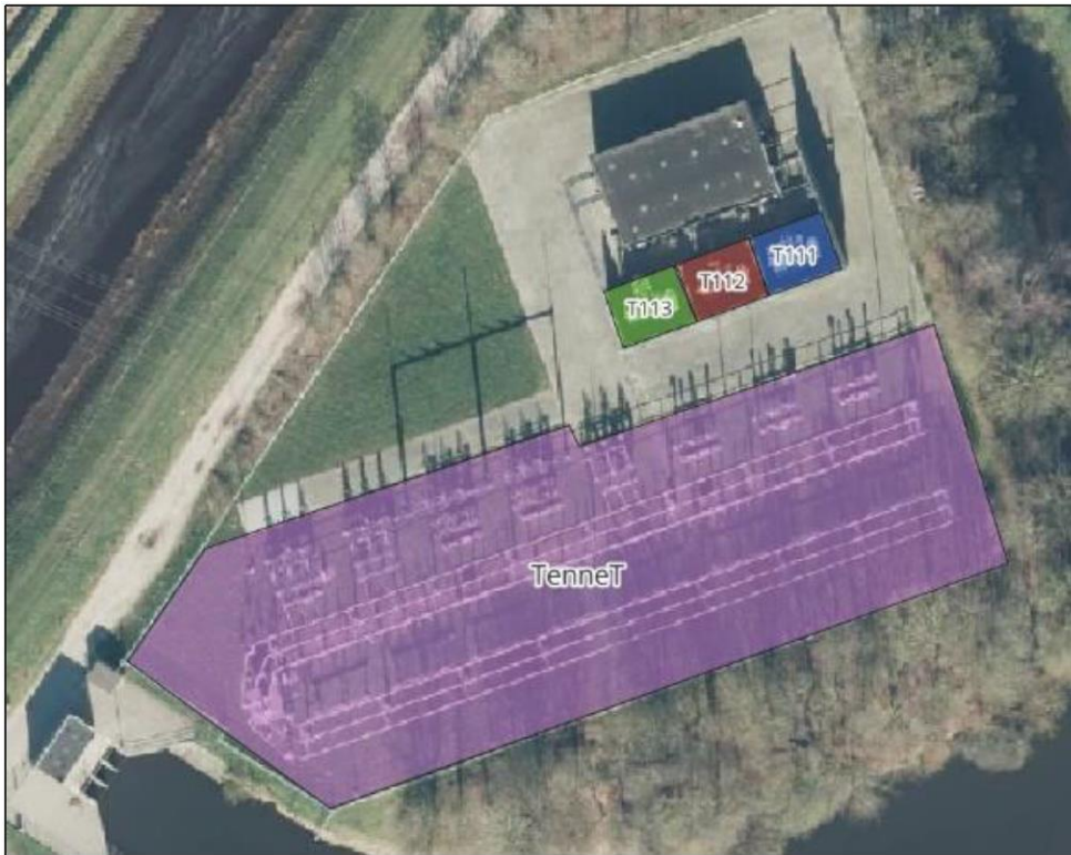
Afbeelding: overzicht van het huidige station. In paars de schakeltuin van TenneT, daarboven de drie transformatoren en het middenspanningsgebouw van Enexis.
